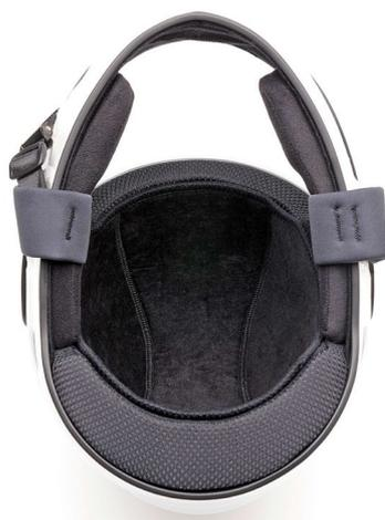
La fodera di comfort, composta da una cuffia in **Coolmax**, è fissata alla calotta interna in polistirolo, tramite una serie di strisce di velcro. È facile da rimuovere. È sufficiente **staccare le strisce di velcro tenendo e tirando le strisce stesse. Non tirate semplicemente la calotta interna dal casco.**
